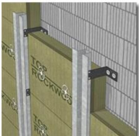
Posa dei profili metallici montanti
